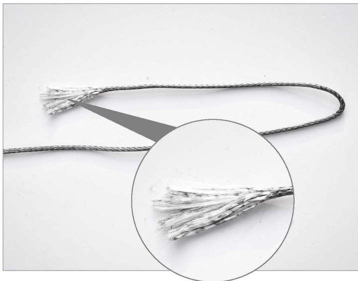
Bild 5: Mit Hilfe des Messers und ggf. auf dem Schneidebrett wird das Leinenende aufgefásert. Wir legen die Litzen frei und dünnen sie aus. Weniger Fasern passen besser durch das Nadelöhr und das Volumen der gedoppelten Leine am Öhr reduziert sich.
