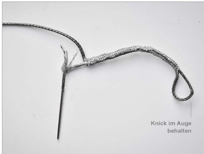
Bild 12: Wir haben weiterhin den geknickten Teil der Bucht im Blick, wenn wir die Nadel abfädeln.
