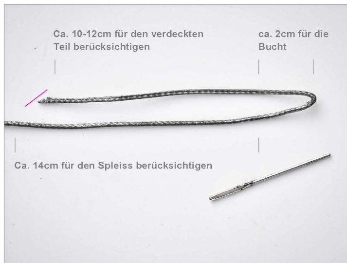
Bild 2: Für die Bucht benötigen wir ca. 2cm, für das im Spleiss verdeckte Ende benötigen wir ca. 10-12cm. Also ab da die Leine knicken und ggf. markieren. Aber ein sorgfältiges Arbeiten trägt die Knickstelle bis zum Ende mit. Das Leinenende schräg beschneiden.
