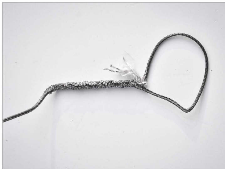
Bild 9: Hier zeigt sich, ob wir zu Beginn das Leinenende genug ausgefasert haben, damit Nadelende plus Leine in den Kanal passen...
