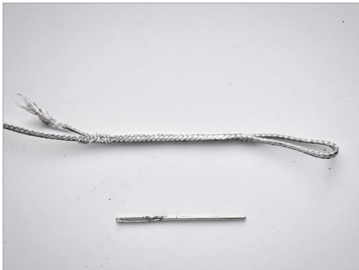
Bild 15: Alternativ kann das Ende auch schon etwas früher aus dem Kanal austreten, dann kann der Spleiss in beide Richtungen (länger und kürzer) korrigiert werden.
