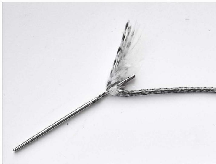
Bild 6: Hier sehen wir, dass wir mit wenigen Fasern besser durch die Nadel kommen und dass wir hinter dem Öhr weniger Volumen (weniger Material) haben, um später durch die Leine zu stechen.
