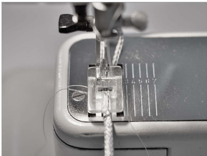
Bild 17: Unter Last zieht sich unser Spleiss dicht und hält. Aber sicherheits- halber mit Nadel und Garn mit ein paar Stichen fixieren oder sauber mit Maschine vernähen.
