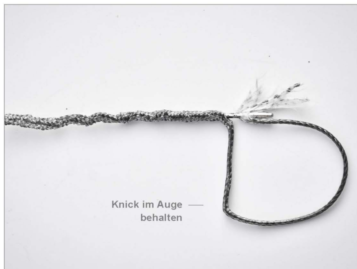
Bild 8: Nun die Nadel durch den gestauchten Bereich der Leine führen. Dabei den Knick im Auge behalten.
