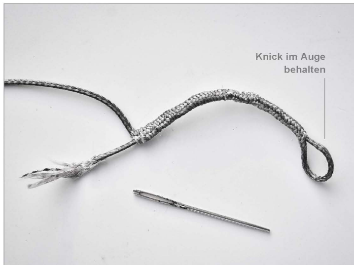
Bild 13: Hier sehen wir, dass wir mit dem Leinenende tiefer im Spleiss stecken, als wir ursprünglich geplant hatten (siehe Knick). Aber da sich die Leine durch den größeren Durchmesser im Spleiss eh etwas verkürzt, wird beim Recken vom Spleiss die Länge millimetergenau definiert.
