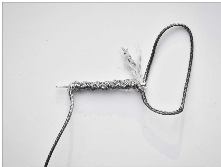
Bild 10: Wir fädeln den gesamten gestauchten Bereich auf die Nadel und ziehen die stumpfe Spitze aus dem Spleiss heraus und knuddeln anschließend Nadel und Leine durch den Kanal. Das kann etwas mühevoll sein.
