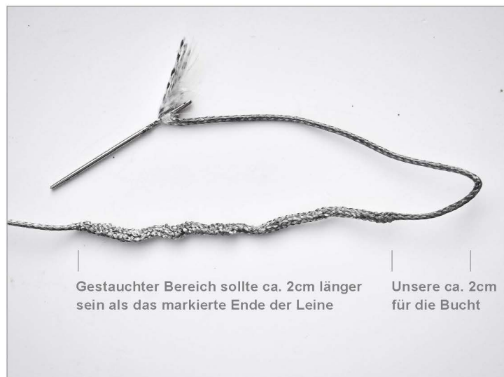
Bild 7: Die Leine wird nun gestaucht und damit aufgebrochen, um Raum zu schaffen für die Durchführung von Nadel und Leinenende. Wenn man sorgfältig vorgeht, entsteht ein sauberer Kanal innerhalb des Geflechts. Vor dem Stauchen sollte der gestauchte Bereich ca. 2cm länger sein als das 10-12cm-Leinenende von Bild 2.
