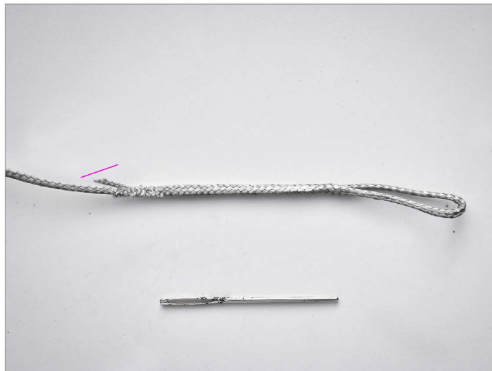
Bild 16: Überstehendes Ende wieder schräg abschneiden und in den Kanal ziehen.
