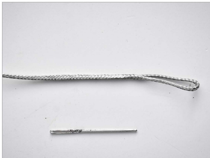
Bild 14: Falls die Gesamtlänge unserer Leine nun etwas zu kurz ist, haben wir die Möglichkeit, den Spleiss zu verschieben. Vorsicht, das geht nur in Richtung Verlängerung (die Bucht wird etwas vergrößert). Zum Verkürzen muss der Spleiss neu angelegt werden. Oder...
