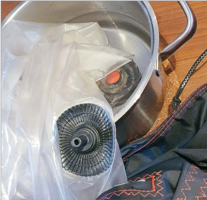
Bild 5: Wir haben zudem den Einlass für den Main-Strut gelöst, um den Bladder etwas weiter herausholen zu können. Ventil und Bladder sind mit einem Kleber verklebt, der sich mit heißem Wasser lösen lässt. Etwa 2 Ltr. Wasser zum Kochen bringen und in einen Topf füllen. Das Wasser hatte ca. 80°C, als wir den Bladder samt Ventil zum Baden geschickt haben.
