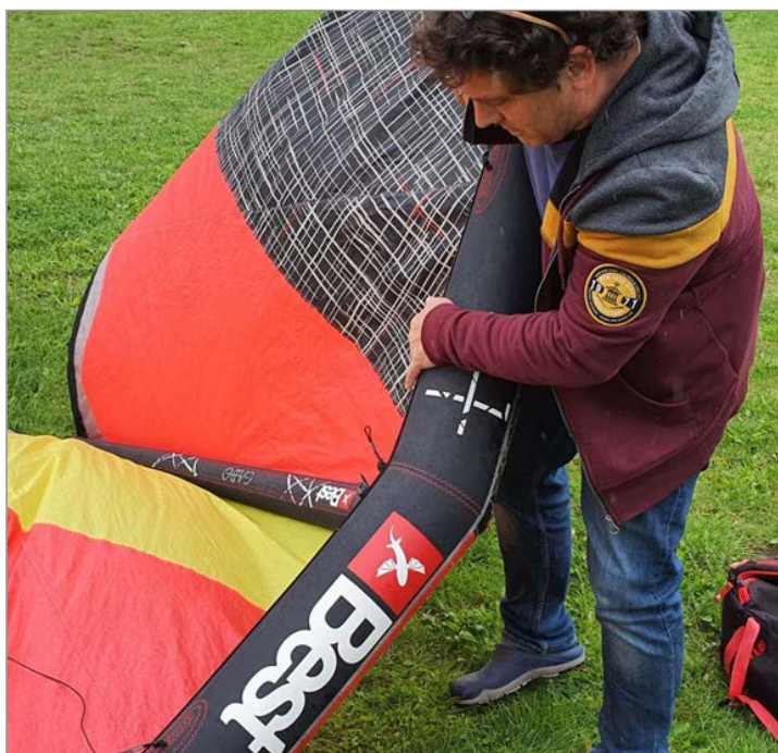
Bild 15: Final gilt es natürlich, die Dichtigkeit zu testen. Dazu wird der Kite vorsichtig aufgepumpt. Wichtig dabei, der Bladder sollte ordentlich im Kite liegen. Wenn Ihr beim Aufpumpen einen Knick im Material entdeckt, wo er nicht hingehört, holt am besten den Bladder nochmal raus...
