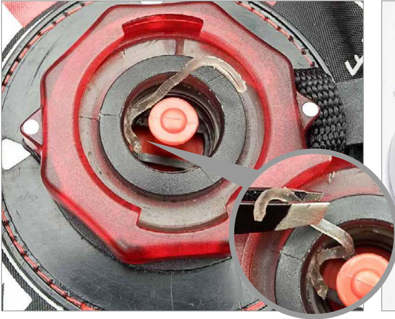
Bild 1: Im konkreten Fall geht's um einen Best Cabo von 2018 bei dem in dem Ventil selbst ein Dichtungsring gerissen ist und der deswegen Luft verliert.
