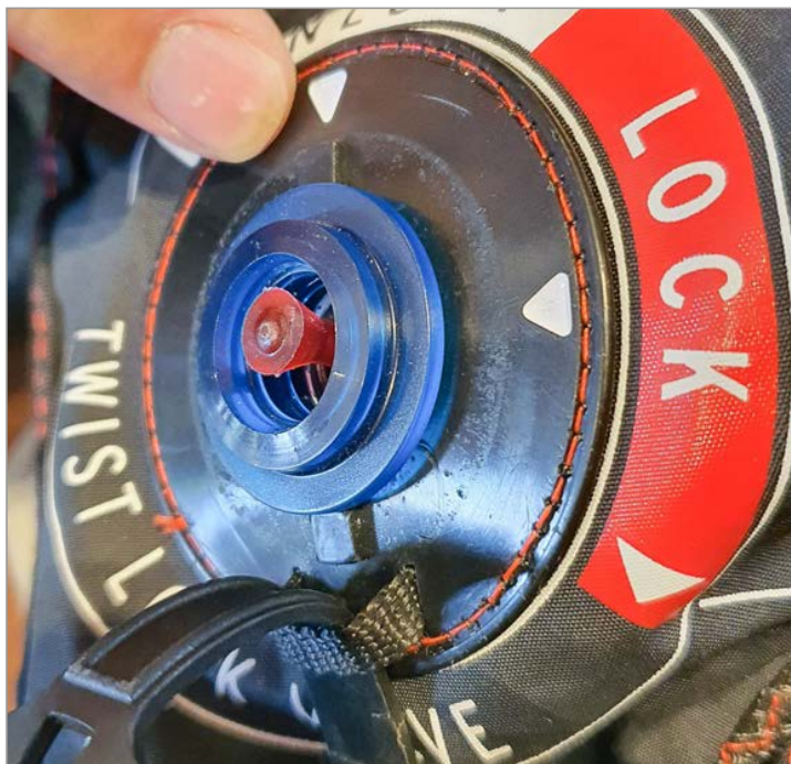
Bild 13: Die letzte Stufe des Zusammenbaus besteht darin, das Ventil wieder an die Ursprungsposition zu bringen.
