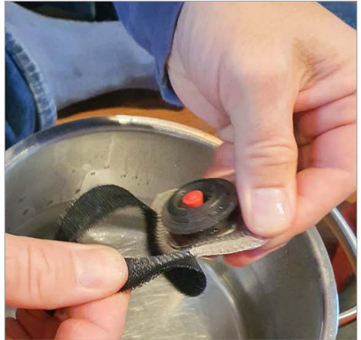
Bild 10: Auch dieser Kleber ist nicht hitzebeständig und kann leicht über heißes Wasser entfernt werden. Und ab jetzt in die andere Richtung – heißt, alles wieder zusammenzubauen.
