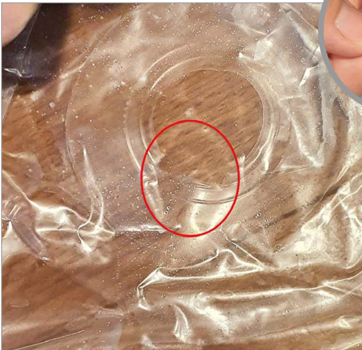
Bild 11: Nachdem der Bladder wieder trocken ist, ist es sinnvoll, sich die Details zu der Stelle anzuschauen, wo das Ventil gesessen hat und wieder platziert werden soll. In unserem Fall war z.B. das Loch nicht „Rund“, sondern hatte eine einseitige Aussparung, für die Rückschlussklappe des Ventils. Daraus war die Richtung des Einbaus direkt vorgeben.
