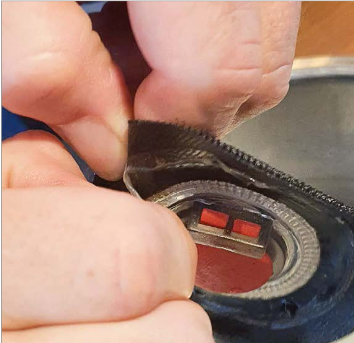
Bild 9: Der zweite Schritt, den wir noch taten, war, den Klettstreifen vom alten Ventil zu entfernen, da das neue Ventil ohne Klettverschluss kam. Wir hatten zu diesem Zeitpunkt noch geplant, den Klettverschluss wieder zu befestigen, entschieden uns aber später dagegen.
