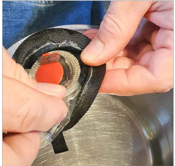
Bild 6: Nach etwa 30 Sekunden im heißen Wasser haben wir den Bladder wieder aus dem Wasser entnommen und vorsichtig versucht, Bladder und Ventil zu trennen. Mit etwas Geduld und zwei bis drei Versuchen haben wir es geschafft!
